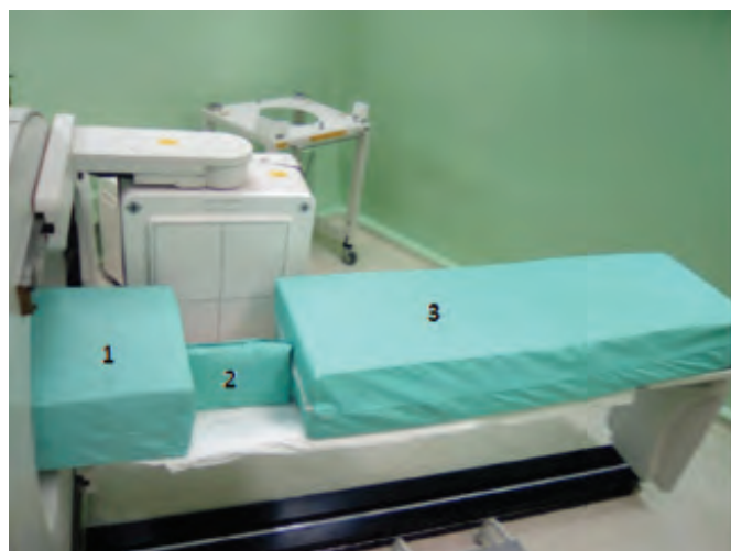
Figura 2. Dispositivo para realizar estudios Gammagráficos de mamas colgantes. 1. Apoyo de los brazos y la cabeza. 2. Separador plomado de las mamas. 3. Apoyo del cuerpo.
