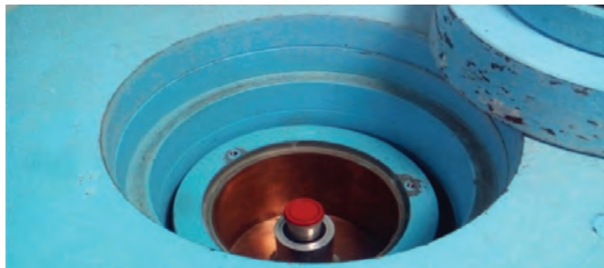
Figura 1. Blindaje, detector y portamuestra.
