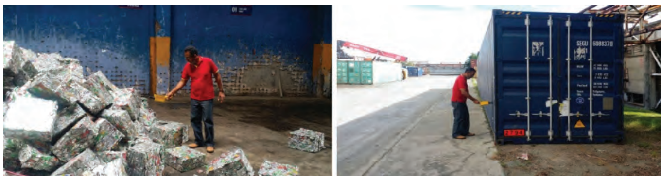
Figura 2. Vigilancia radiológica de chatarra apilada y en contenedores con detector portátil.
