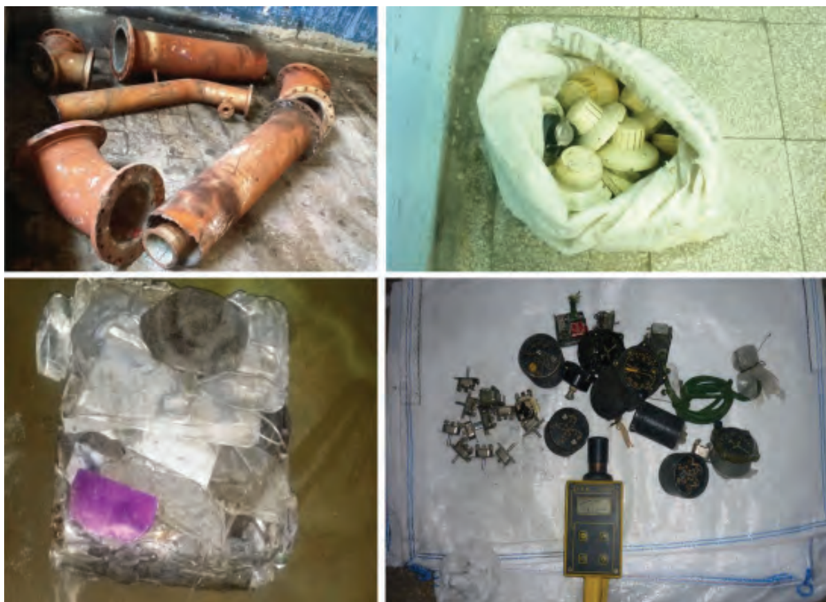
Figura 3. Principales piezas encontradas contaminadas con material radiactivo.
