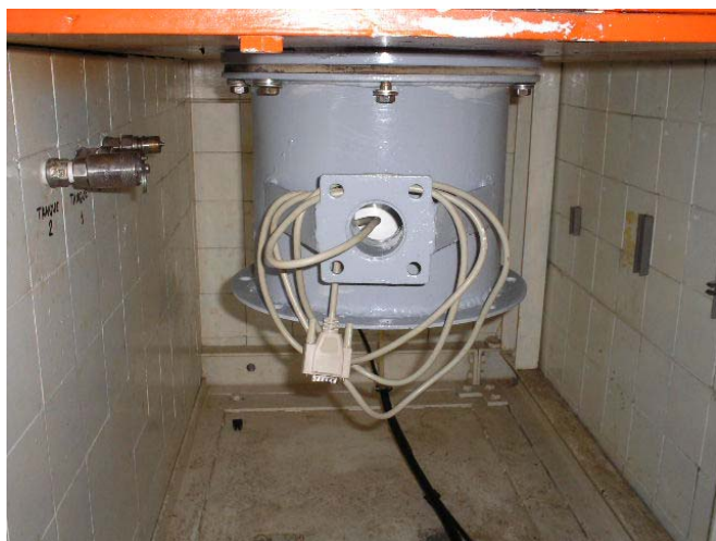
Figura 4. Soporte del pozo de calibración.
