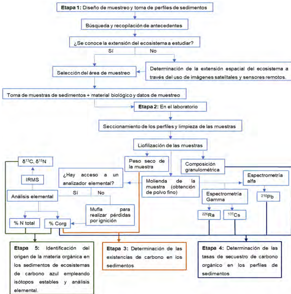
Figura 1. Diagrama de flujo que describe la guía para el estudio de secuestro de carbono en sedimentos de ecosistemas de carbono azul cubanos utilizando técnicas nucleares e isotópicas.
