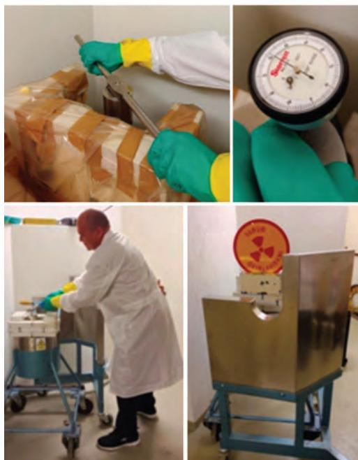
Figura 4. Extracción de las FRD de los portafuentes.
