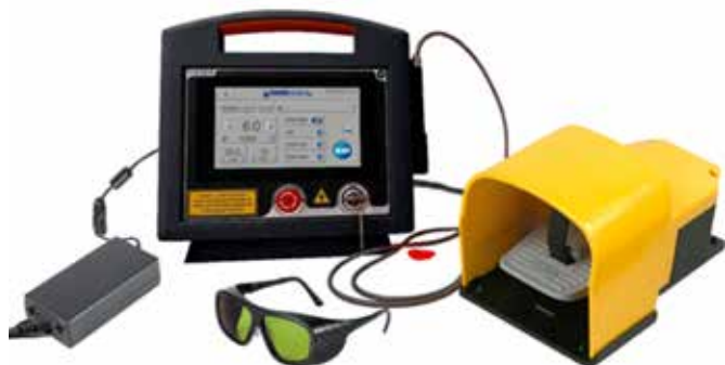
Figura 6. Equipo láser de potencia para cirugía estomatológica FISSEHighBeam10w.
