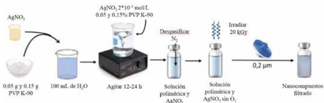
Figura 13. Esquema de instalación experimental para la síntesis de nanocompuestos PVP-Ag.
