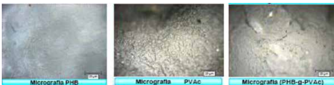
Figura 2. Imagen del PHB, PVAc y PHB-co-PVc por microscopía óptica de alta resolución.
