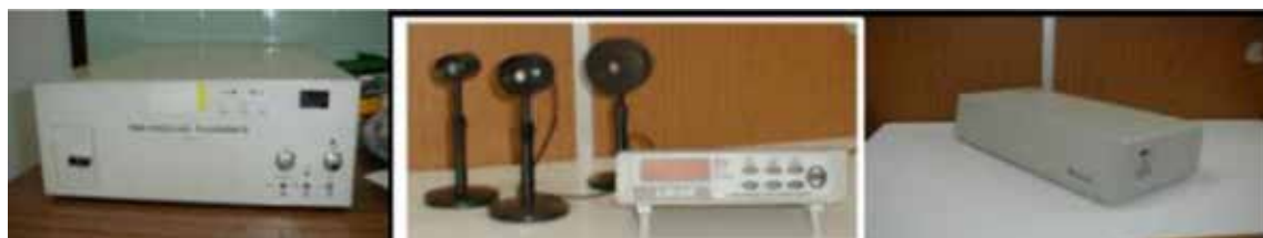
Figura 1. A la izquierda el fluorímetro con resolución temporal LF2, en el centro el medidor de energía y potencia láser LM-09 y a la derecha el láser de nitrógeno LN-03
