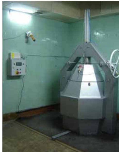
Figura 3. Irradiador ISOGAMMA LLCo
