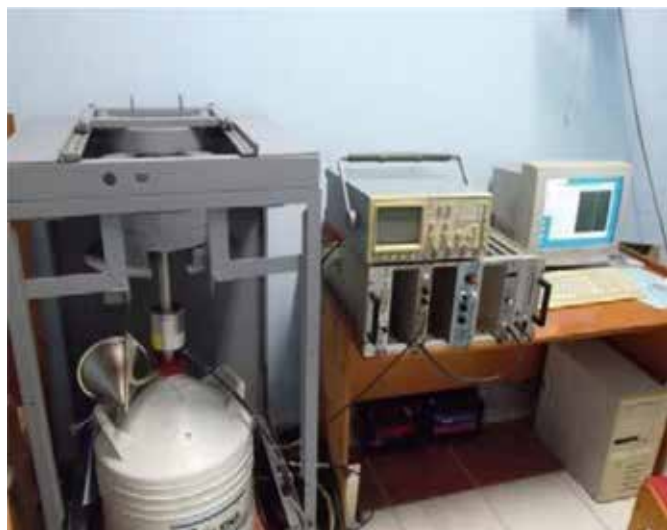
Figura 4. Sistema espectrométrico gamma de bajo fondo.
