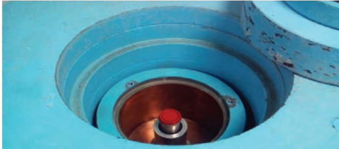
Figura 1. Blindaje, detector y portamuestra.
