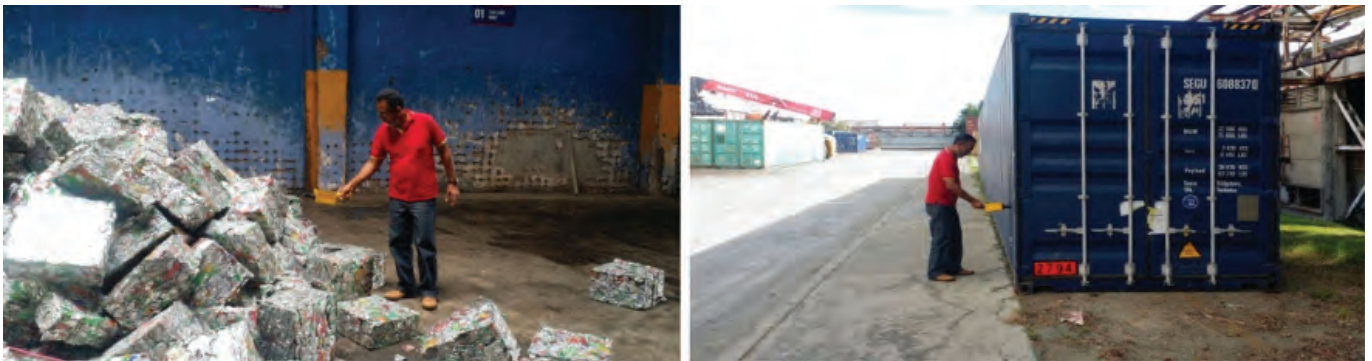
Figura 2. Vigilancia radiológica de chatarra apilada y en contenedores con detector portátil.
