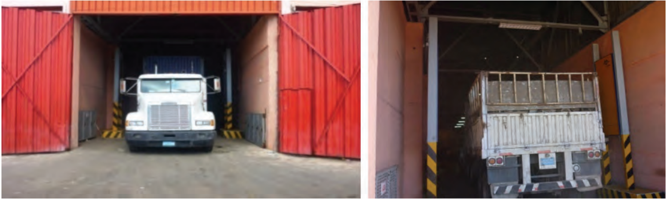
Figura 1. Vigilancia radiológica de chatarra en contenedores y camiones con detector estacionario.
