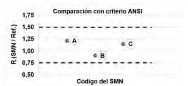
Figura 3. Comparación de las desviaciones obtenidas con el criterio de aceptación del ANSI: 0,75 < R < 1,5 .
