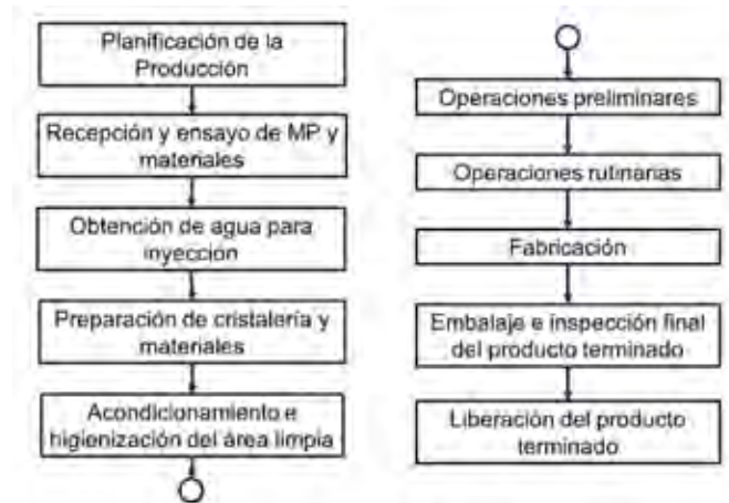
Figura 1. Diagrama de flujo del proceso de producción de inyectables liofilizados de anticuerpos monoclonales, que se desarrollan en el Centro de Isótopos, para la marcación con Tecnecio-99m (Subprocesos).
