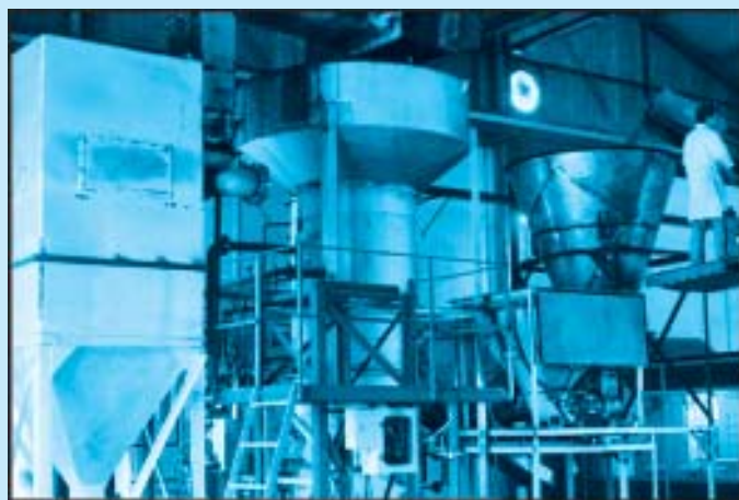
Figura 4. Planta piloto de combustión con lecho fluidizado burbujeante de 1 MW-CEDER (Soria).
