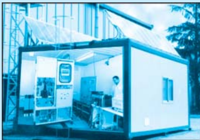
Figura 5. Primer proyecto español para la conservación de la energía solar. Generación y consumo de hidrógeno en pila de combustible.
