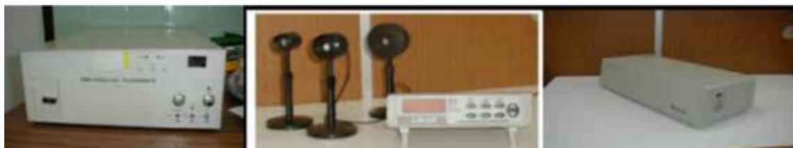
Figura 1. A la izquierda el fluorímetro con resolución temporal LF2, en el centro el medidor de energía y potencia laser LM-09 y a la derecha el láser de nitrógeno LN-03
