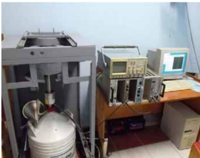
Figura 4. Sistema espectrométrico gamma de bajo fondo.
