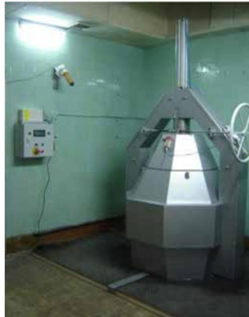
Figura 3. Irradiador ISOGAMMA LLCo
