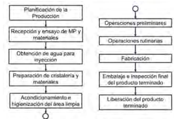
Figura 1. Diagrama de flujo del proceso de producción de inyectables liofilizados de anticuerpos monoclonales, que se desarrollan en el Centro de Isótopos, para la marcación con Tecnecio-99m (Subprocesos).
