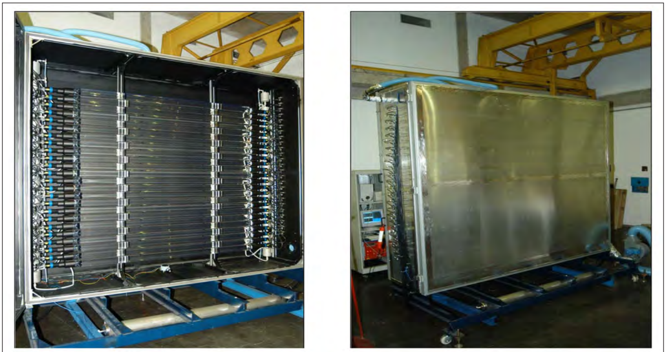
Figura 1. Fotos mostrando la pared de neutrones dentro do compartimento fabricado com finas láminas de aluminio.
