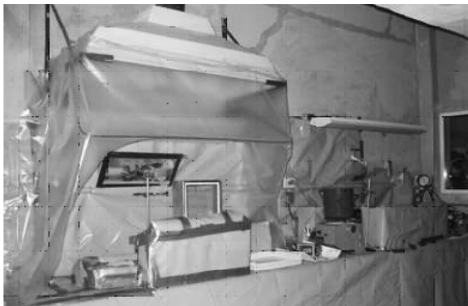
Figura 2. Puestos de trabajo para el acondicionamiento del Ra-226 (PT2, PT3 y PT4).
