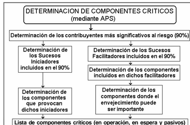
Figura 1. Algoritmo de determinación de componentes críticos para el RCM partiendo del APS.
